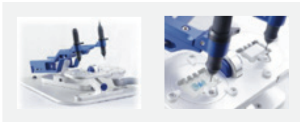
Figuras 13A y 13B: Sistema para fresado manual de bloques de zirconio presinterizado Ceramill (Girrbach). Obsérvense las dos puntas del dispositivo. La ubicada sobre la izquierda de la imagen copia la forma del encerado de la estructura, y la fresa (sobre la derecha) desgasta el bloque de zirconio preseinterizado reproduciendo la forma. El sistema se acciona en forma totalmente manual y recuerda a un sistema de duplicado de llaves. Una vez modelado el bloque de zirconio, se retira de platina para su sinterización final en un horno. Luego se hacen los ajustes finales sobre el modelo. Las imágenes son gentileza de la compañía Olympic Dental.
